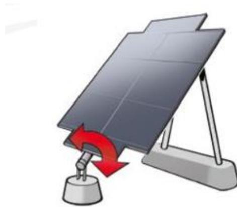
Schéma 8 : Illustration d'un suiveur est-ouest avec un axe incliné (Source : Solar Choice Pty, Ltd, 2010)
